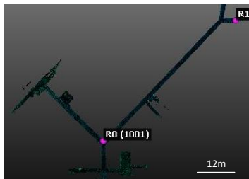
Fig. 1 : Fragment du nuage Hovermap après consolidation des acquisitions
