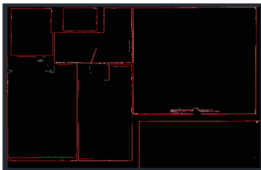
Figure 4: Vectorisation des murs d'un appartement
