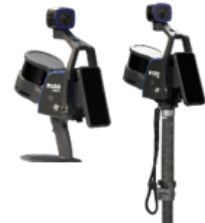
Fig. 1 : Système FARO Orbis monté sur poignée et monopod
