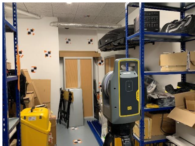
Figure 4. Mise en place d'un quarantaine de cibles pour le premier prototype de la salle d'auto-calibration.
