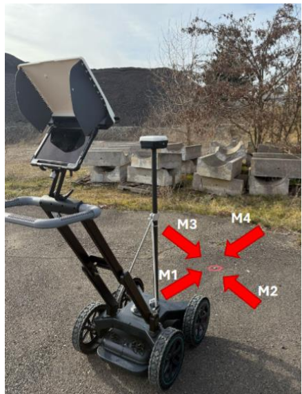
Fig. 5 : Test de répétibilité GPR sur clou géoréférencé
