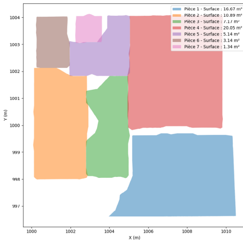
Figure 3: Calcul de surface d'un appartement obtenu avec un scanner laser
