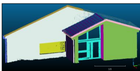
Fig. 4 : Résultat de la segmentation - Une couleur aléatoire par plan
