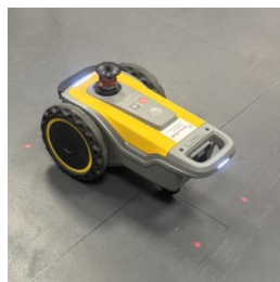
Figure 3 : Le robot traceur HP SitePrint
