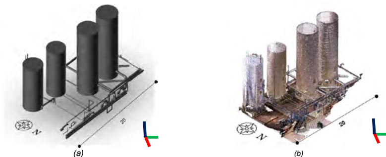
Fig. 3 : (a) résultat de la modélisation des tuyauteries et cuves pour le logiciel Edgewise avec le nuage de points référence (b)
