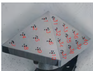
Fig. 7 : Résultat des détections de centre et du décodages des cibles sur la mire de calibration
