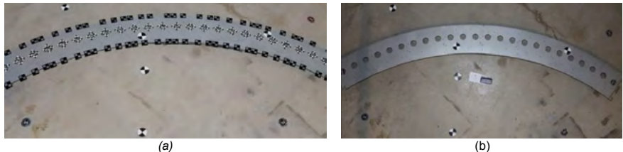
Fig. 3 : (a) Structure avec les cibles, et (b) Structure sans cible.
