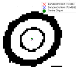
Fig. 8 : Résultat visuel du centre calculé à partir du barycentre d'une cible
