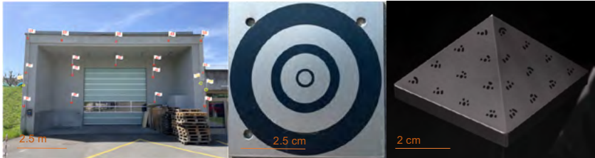
Fig. 2 : (a) Polygone d'étalonnage, (b) cible utilisée sur le polygone, (c) Mire de calibration
