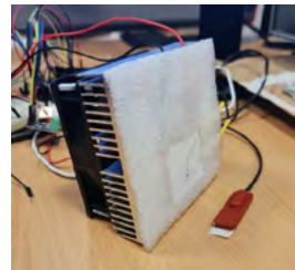
Fig. 5 : Chambre climatique pour un capteur
