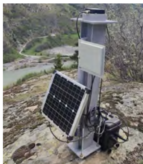
Figure 1 : Installation d'un Geocube de référence
