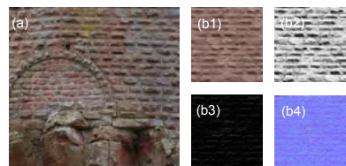
Fig. 4: (a) photographie brute prise sur le terrain ; (b1) albedo map ; (b2) height map ; (b3) specular map ; (b4) normal map
