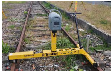
Fig. 4 : Photo du Trimble Gedo Scan
