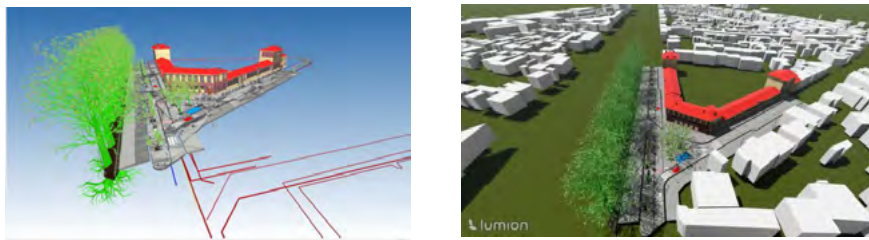
Fig 7 : Export de la maquette dans un viewer (format IFC) et dans un logiciel photo-réaliste Lumion (format COL-LADA)
