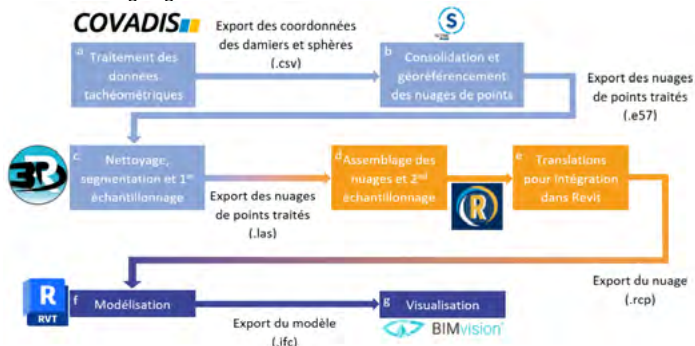
Fig. 2 : Processus de traitement des données brutes pour arriver au modèle 3D livrable
