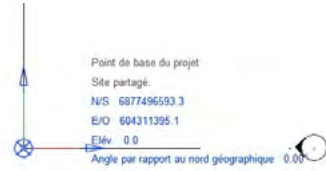
Figure 4 : Géolocalisation sur Revit
