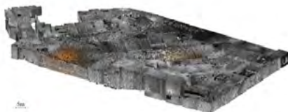
Fig. 3 : nuage de points résultant de l'acquisition et traitement des données
