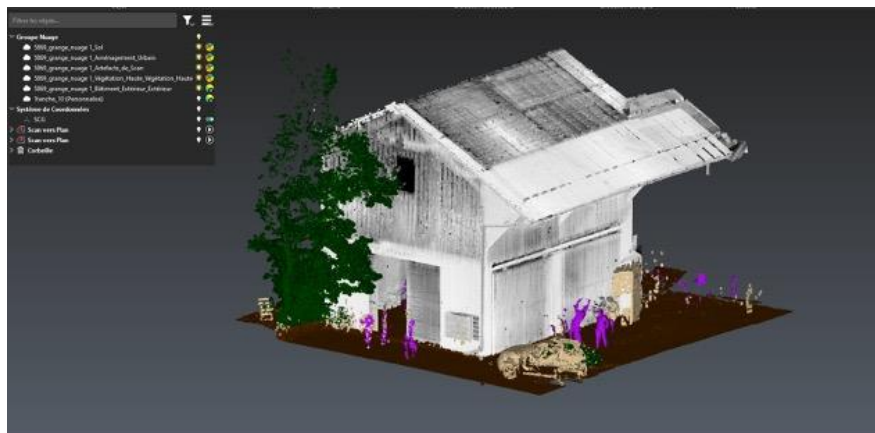
Fig. 1 : Classification "Outdoor" appliquée sur un nuage de points dans le logiciel Leica Cyclone 3DR
