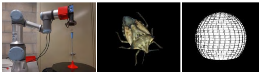
Fig. 1 : Robot utilisé pour l'acquisition, exemple de spécimen (taille de 1 cm) et schéma d'acquisition générique.
