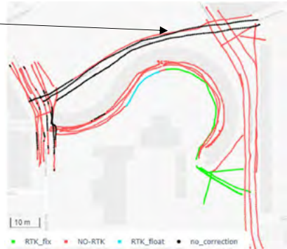
Fig.4 : Carte des positions des images en fonction du signal GNSS
