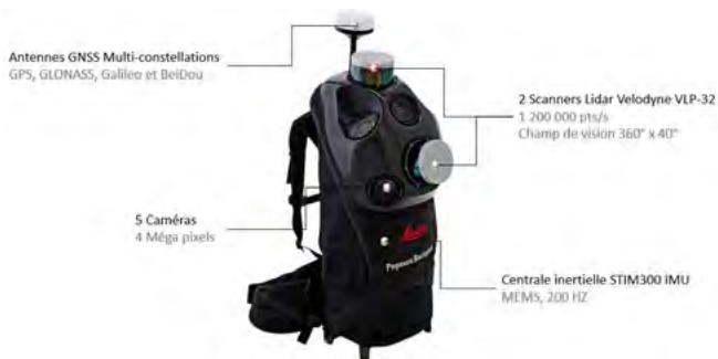
Fig. 1 : Description du Leica Pegasus Backpack
