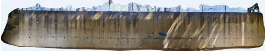
Fig. 4 : Orthophoto obtenue à partir de l'acquisition de l'objectif grand angle du Samsung Galaxy A31 (sans échelle)
