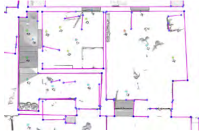
Fig. 6 : Détection automatique des murs pour un plan d'intérieur par PointCab
