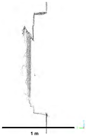
Fig. 5 : Fusion des nuages de points issus des acquisitions par SLT depuis le sol et par le BLK2FLY Fenêtre du 9ème étage Vue de profil
