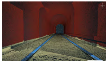
Fig. 2 : Détection automatique des rails par TCP sur des projets linéaires ferroviaires
