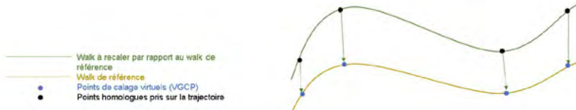
Fig. 4 : Illustration d'un recalage à l'aide de VGCP
