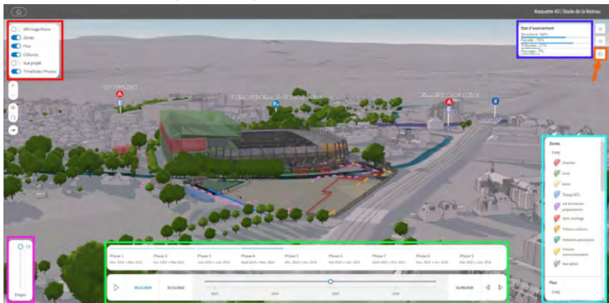
Fig. 3 : Interface de la maquette 4D de l'application web avec les différents widgets encadrés en couleur.
