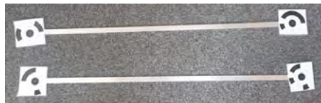
Figure 3 : Barres de mise à l'échelle utilisées
