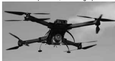
Figure 1 : Drone RICOPTER et son système LiDAR en vol
