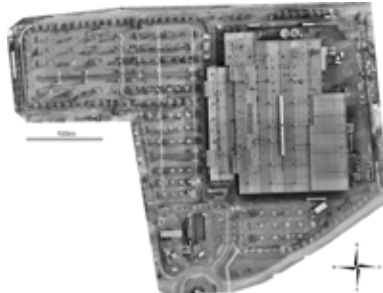
Figure 3 : Orthophoto d'une résolution de 1 cm pour la mise à jour du plan topographique
