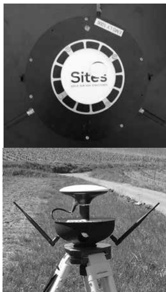
Figure 3 : Récepteur GNSS-RTK mobile (sur le drone) en haut et récepteur GNSS-RTK de base en bas
