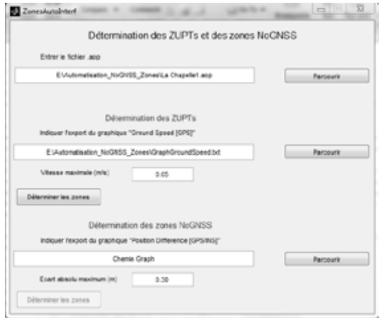
Figure 4 : Interface graphique du programme réalisé sous Matlab. L'objectif est de sélectionner le fichier de travail du logiciel de couplage puis d'indiquer les différents graphiques à analyser. Le programme génère alors les zones et les introduit directement dans le fichier de travail. Les zones seront alors considérées à la guise de l'utilisateur dans le calcul de couplage.
