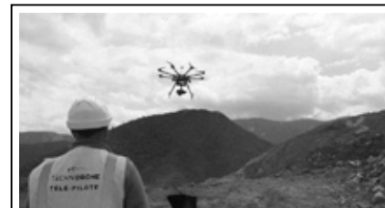
Figure 1 - Mission de relevé photogrammétrique par drone en carrière
