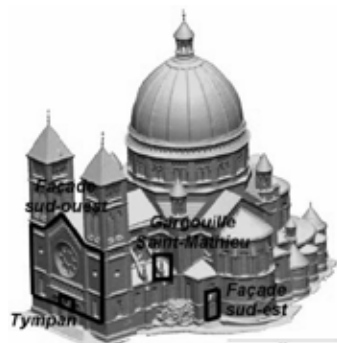
Fig 4. Modèle maillé de l'église et analyses faites en utilisant les données laser en tant que référence.
