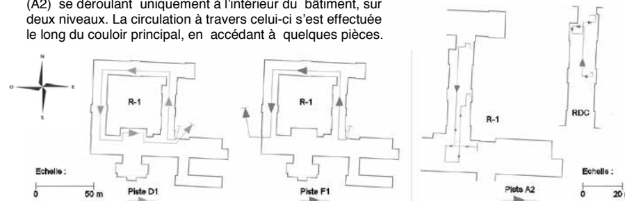
Figure 2 : Schématisation des acquisitions réalisées avec le Leica Pegasus Backpack.
