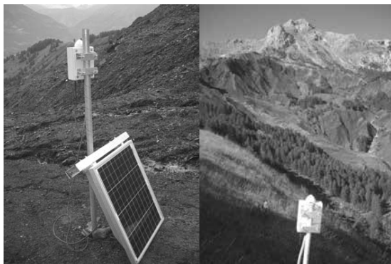
Figure 3 : A gauche, présentation d'un récepteur GEOMON installé sur le glissement, à droite, présentation du récepteur GEOMON situé hors glissement et servant actuellement de référence.
