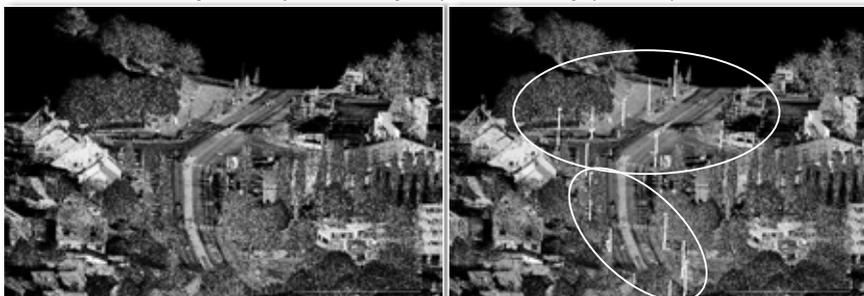
Figure 4 : Extraction des points du nuage (à gauche : nuage d'origine, à droite : superposition du nuage avec les points extraits (marqués par les ellipses blanches)
