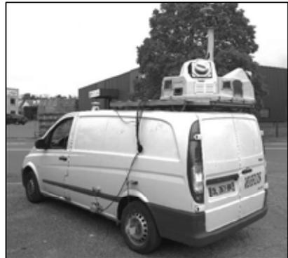
Figure 1 : Système Lynx SG-1 sur véhicule
