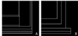
Figure 3 : Comparaison d’un détail d’une fenêtre exportée au format DWG depuis REVIT. L’objet A est une famille constructeur et l’objet B est la famille que j’ai créée.
