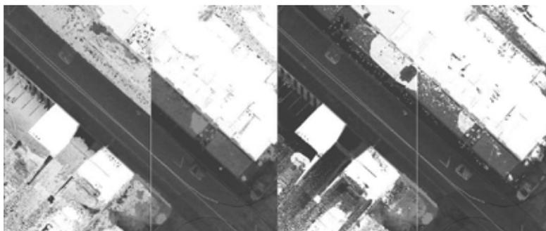
Figure 3 : Mise en évidence des différences sur les ortho-LiDAR issues de l'ancienne méthode, à droite, par rapport au nouveau processus, à gauche.
