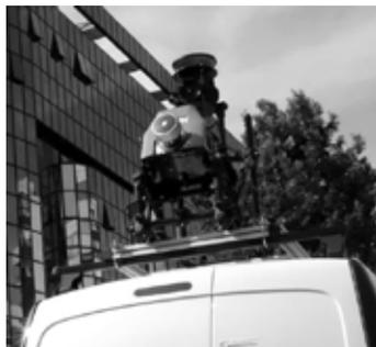
Figure 1 : ROBIN Precision monté sur le véhicule d'acquisition
